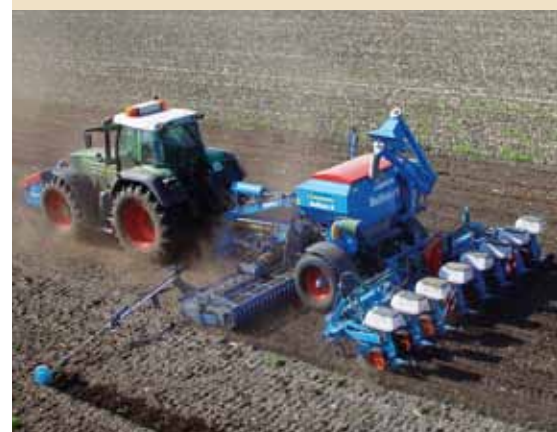
Равномерное распределение веса при помощи разгрузки шасси
