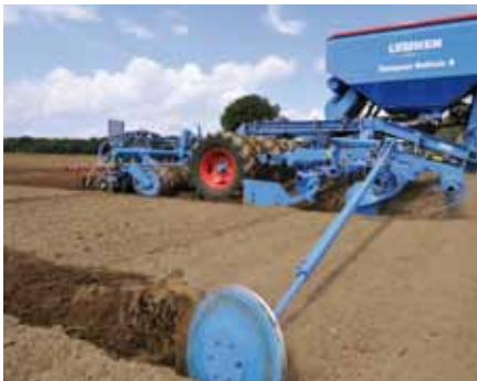
▶ Маркер с болтовой защитой на срез
